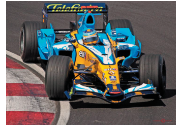
Obrázek 4-6. Díky druhému Newtonovu zákonu víme, proč se konstruktéři závodních aut tolik starají o to, aby byl závodní stroj co nejlehčí. Čím menší je hmotnost tělesa, tím větší zrychlení mu dokáže daná síla udělit. Celková hmotnost současného vozu F1 je i s pilotem a plnou nádrží kolem 600 kg.
