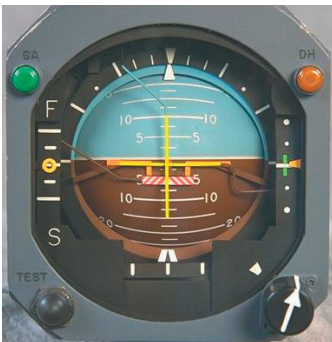
Obrázek 7-16. Umělý horizont z letadla. Uvnitř koule, zobrazující umělý horizont, je setrvačnick s osou kolmou k zemskému povrchu. Koule samotná je umístěna v závěsech, které umožňují její otáčení do všech stran a napájení elektrickým proudem. Po zapnutí se setrvačnick roztočí a udržuje přístroj ve stále stejné poloze vůči zemskému povrchu.
