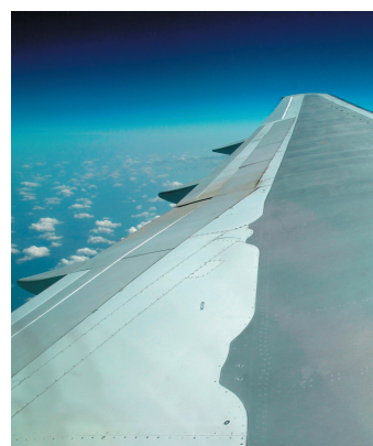
Obrázek 8-17. Takto můžete vidět křídlo letadla Boeing 777 přímo z jeho paluby. Proudící vzduch právě na toto křídlo působí aerodynamickou vztlakovou silou přes 1000000 N, neboť celé letadlo váží přes 200 tun.
