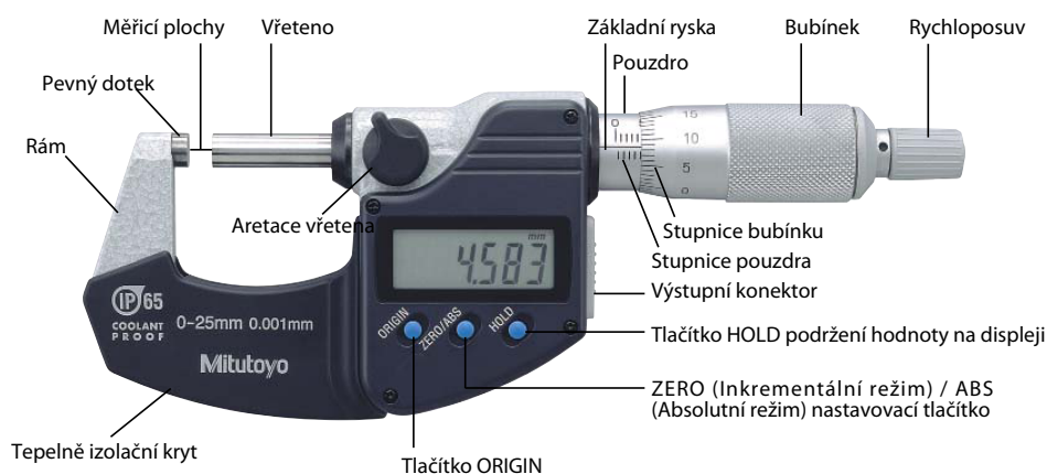
Obrázek 5: Mikrometr s analogovými stupnicemi a digitálním displejem. V elektronické verzi si lze obrázek prohlédnout při větším zvětšení.
