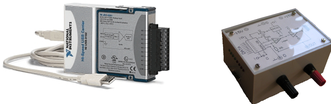
Obrázek 3: Dva D/A převodníky: vlevo profesionální 4-kanálový 16-bitový převodník USB-9263 firmy National Instruments, vpravo jednoduchý osmibitový D/A převodník MDAC-08
