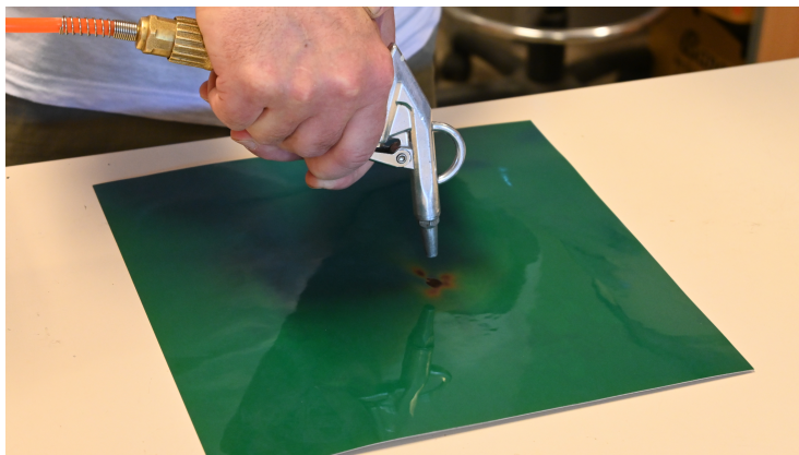
Obrázek 9: Adiabatická expanze na teplotlivé fólii.
