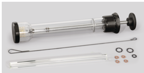
Obrázek 11: V pomůcce PASCO Compression Igniter lze adiabatickým dějem dosáhnout zápalné teploty pyrolyzované vaty.
