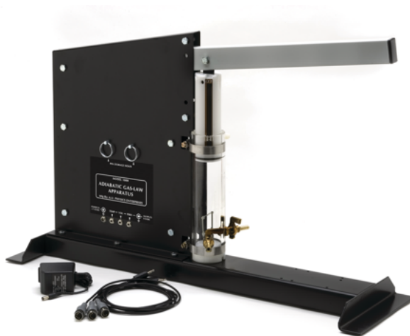
Obrázek 11: V pomůcce PASCO Compression Igniter lze adiabatickým dějem dosáhnout zápalné teploty pyrolyzované vaty.
