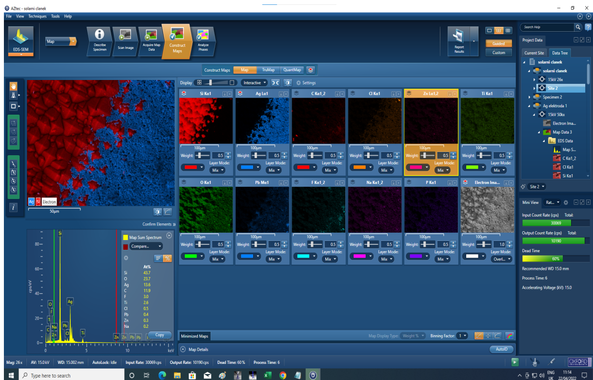
Obr. 6 Kompletní prvková analýza čipu a kontaktu. Snímek okna programu pro EDX analýzu, se kterým operátor SEM pracuje.
