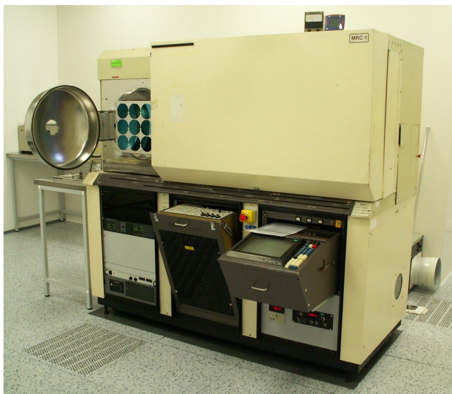
Obrázek 7.9. Naprašovačka MRC 603 s otevřenou předávací komorou, ve které je paleta s devíti naoxidovanými deskami.
