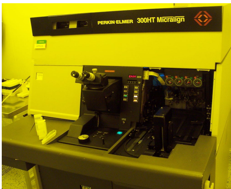
Obrázek 5.8. Expoziční zařízení (optický litograf) Perkin-Elmer 340 HT a detailní pohled na unašeč se založenou deskou.
