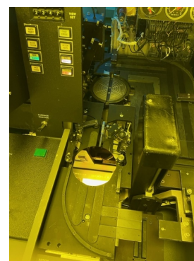
Obrázek 5.8. Expoziční zařízení (optický litograf) Perkin-Elmer 340 HT a detailní pohled na unašeč se založenou deskou.
