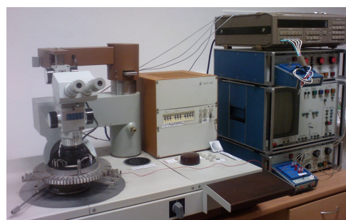
Obrázek 9.12. Hrotové měření ručním přiložením hrotů (vlevo) a pomocí specializované stanice hrotového měření (vpravo).
