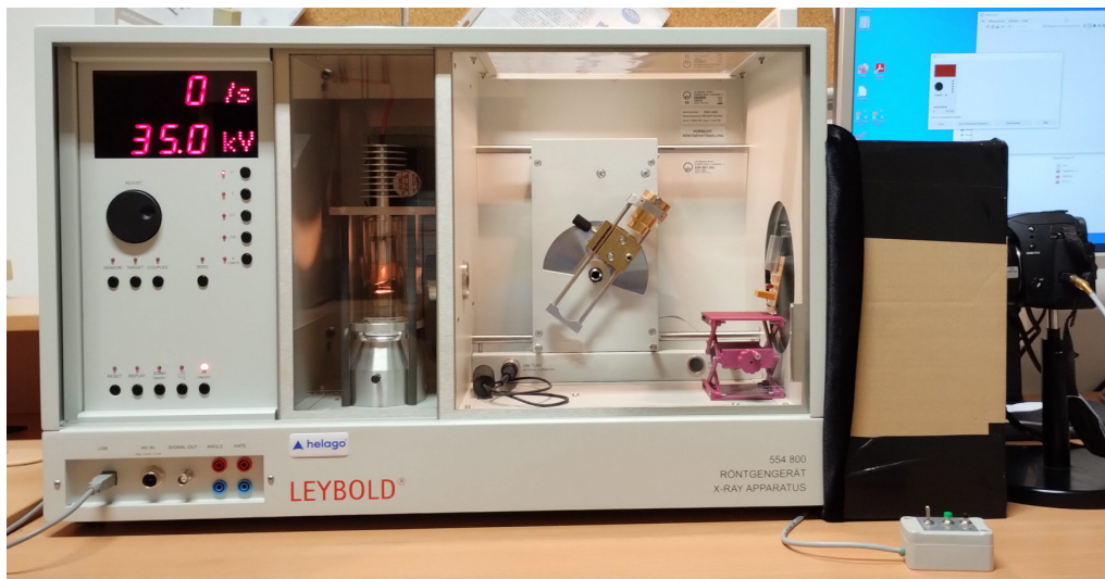
Obrázek 7.4. Školní rentgenový zdroj Leybold. Detailní pohled na difraktometr, černý box chránící fluorescenční stínítko, digitální zrcadlovku s objektivem v černém boxu a ovládáním snímání pomocí drátové spouště (dole).
