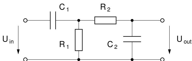
Na vstup propusti vložme časově závislé napětí ve tvaru tzv. chirpu
