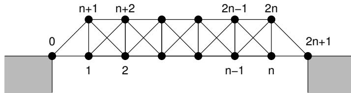
Označíme-li  $\mathbf{x}$  a  $\mathbf{y}$  vektory horizontálních a vertikálních výchylek z vyobrazené polohy (vektory mají  $2n$  komponent), lze harmonické kmitové módy mostu nalézt řešením vlastních problémů
