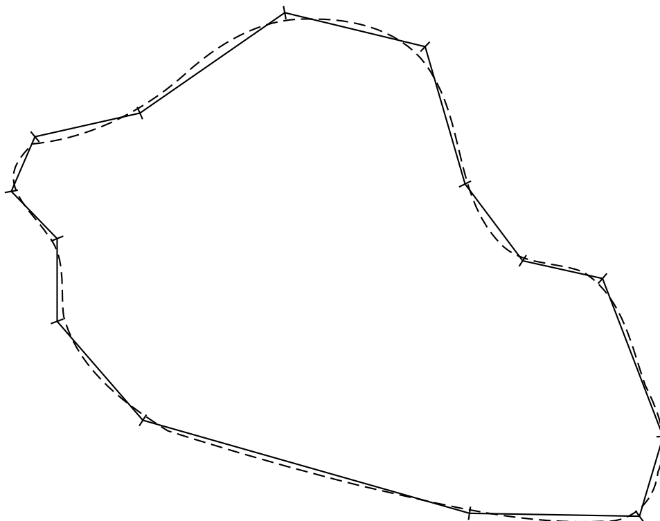
Obrázek 1.3: Dislokační smyčka a její nahrazení lomenou čarou.
